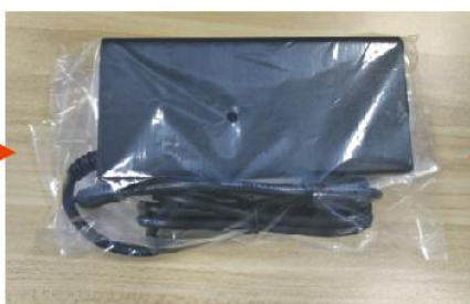
1. 产品放入PE袋 2. PE袋尺寸: L230mm*W190mm
