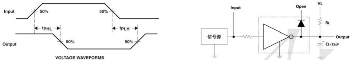
图 6 传输延迟测试电路
