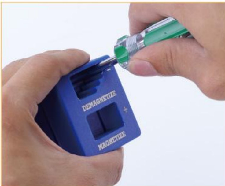
3.将螺丝起子放入消磁窗口并紧靠阶梯快速抽出，如无达到消磁效果，请重复该动作
