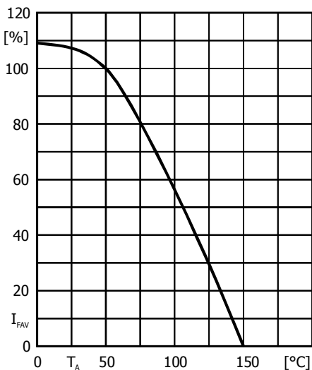
Rated forward current versus ambient temperature Zul. Richtstrom in Abh. von der Umgebungstemp.
