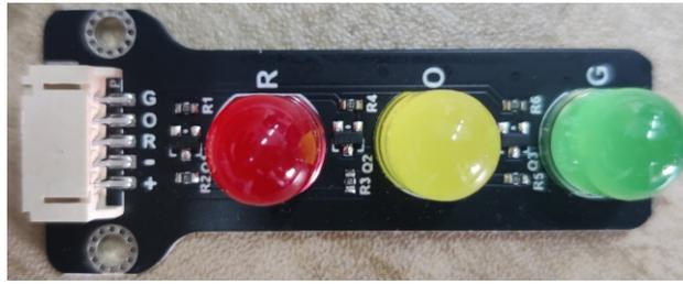
产品详情及参数：是由红绿黄三个颜色不同的led组成，每个led单独控制，通过高低电平实现led的亮灭状态。
