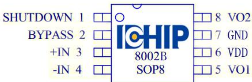
图 2. 8002B SOP-8 封装管脚分布图
